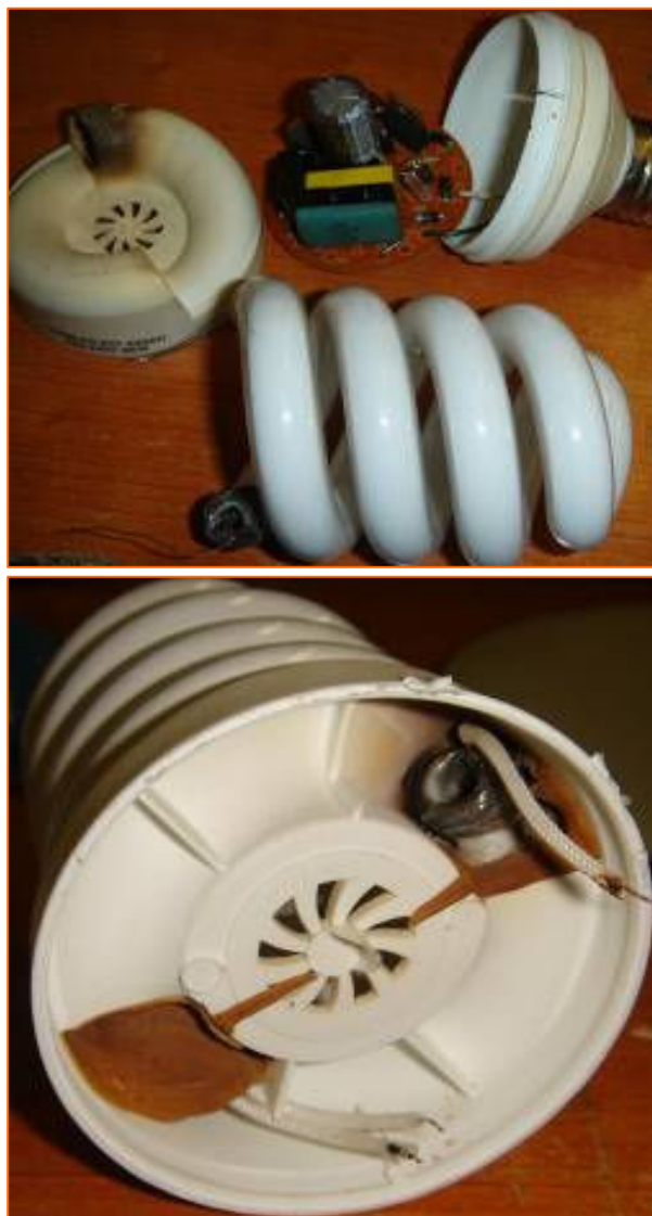
Фото 2. Вышедшие из строя низкокачественные КЛЛ (оплавилась колба) (Фото с сайта iXBT.com, участник: short_circuit)
