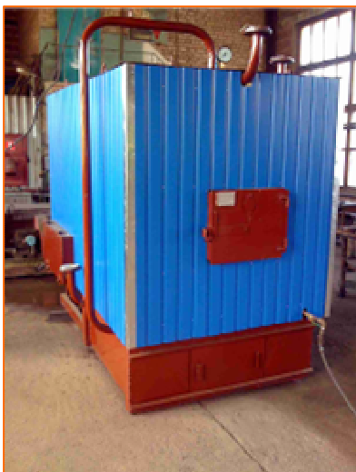
Фото 1. Водогрейный котел ВК-1.0 мощностью 1 МВт
