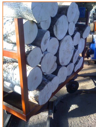
Фото 2. Грузовая тележка с двумя поворотными осями для доставки дров в котельную по зигзагообразной колее
