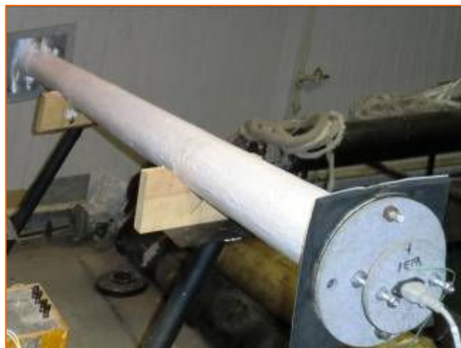
Рис. 2. Стенд для измерения коэффициента теплопроводности методом трубы, использовавшийся для тестирования материалов
